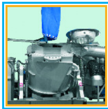
Frontansicht Beladen - Die Trommel kippt bis zu 70° nach oben
