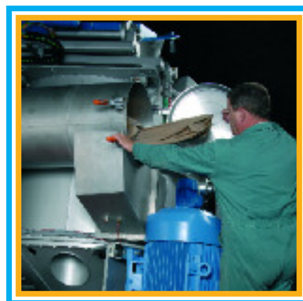
Reinigen des Flusenfilters - Trommelgehäuse in Beladeposition
