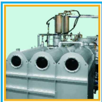
Reinigen des Flusenfilters - Trommelgehäuse in Beladeposition
